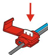
4. Задавите металлическую часть «зажим» в тело провода, не повредив медную жилу кабеля.
