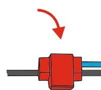
5. Зафиксируйте «зажим» сверху пластиковым изолятором до щелчка.
